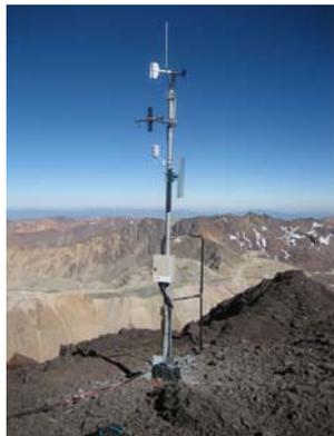
Für die Messung ist ein Standort im Bereich des Geländeübergangs zwischen Erosions- und Ablagerungszone ideal. Die stangenförmigen, vertikalen Sensorelemente werden knapp über der Schneeoberfläche montiert. Um eine Bedeckung der Sensoren zu vermeiden, darf am Stationsstandort keine mächtige Schneedecke liegen. Ausserdem ist bei der Standortwahl auf die Wächtenbildung im Bereich der Geländekante zu achten.
