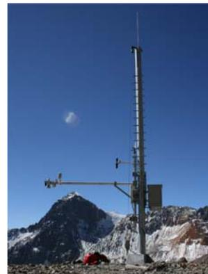
Ausserdem erlaubt der modulare Aufbau der Station einen schnellen Ersatz fehlerhafter Komponenten sowie einfache Reparaturarbeiten vor Ort.
