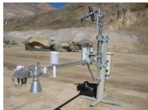
Die gesamte Elektronik und Sensorik inklusive Solarzelle und Stationsschrank wird im Tal auf einer Trägerkonstruktion vormontiert, in Betrieb genommen und getestet.
